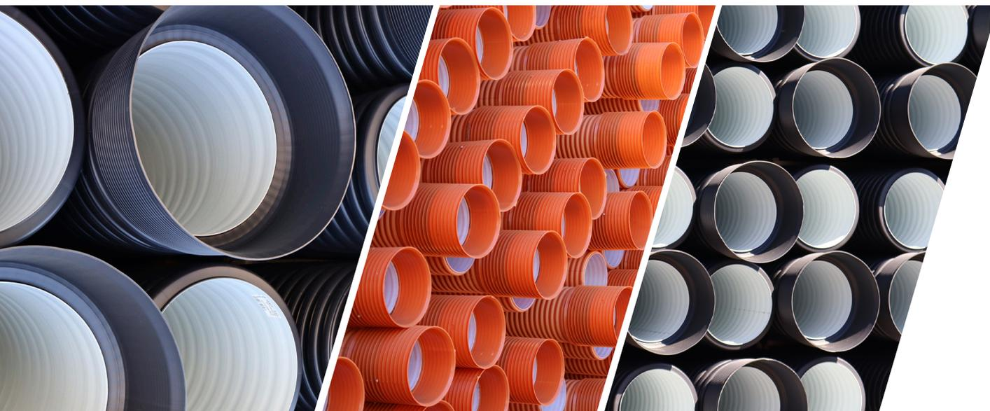
Os tubos são fabricados em polipropileno ou polietileno de parede corrugada. O tubo Ambidur é obtido por co-extrusão possuindo uma parede dupla, apresentando uma parede externa corrugada de cor preta/ocre exterior - cor interior branca SN8 ou preta SN4. A bolsa da tubulação Ambidur é do tipo integral e liso, constituindo assim, um corpo único.
